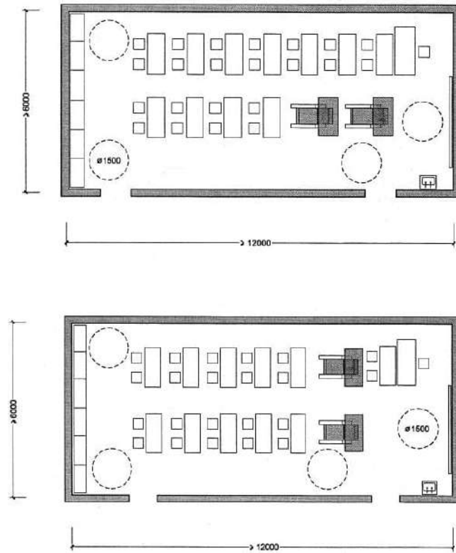
Рисунок Б.3 - Варианты планировочных решений классных помещений площадью 60-70 кв. м
